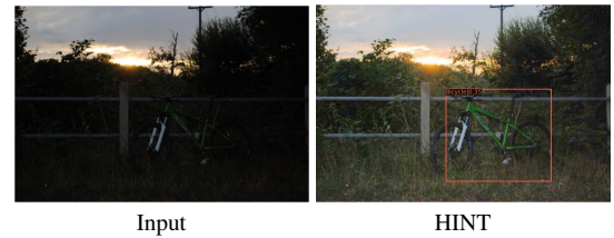
Figure 9. 低光目标检测对比。与低光输入（左）相比，检测器能在经HINT恢复图像（右）上预测出定位准确边界框。
